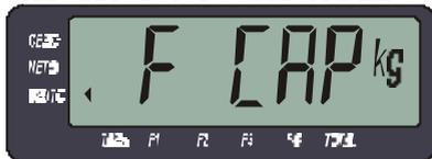
Este mensaje indica que la señal proveniente de la celda es superior a la máxima admisible.
