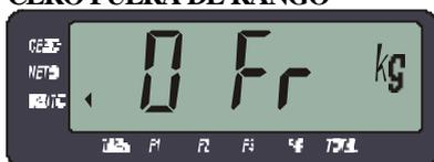
Usted intentó tomar cero (o la balanza esta configurada con la opción de autocero en el arranque) y la lectura supera el 2% de la capacidad máxima.
