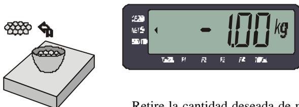
Retire la cantidad deseada de material, viendo la misma en el display del indicador, con el signo negativo debido a que ha hecho un retiro.
