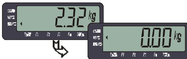
Coloque sobre la plataforma el recipiente a destarar. Pulse
