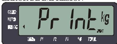
Este mensaje indica que el equipo no puede entablar comunicación con el dispositivo externo. Solo se presenta si la comunicación es con handshake y significa que no recibe autorización para transmitir (CTS).
