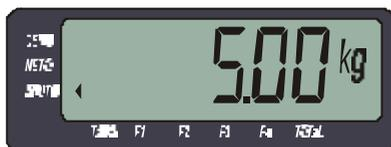
Coloque el objeto a pesar sobre la balanza y lea en el indicador el peso una vez que se haya apagado el indicador de movimiento (MVTO).
