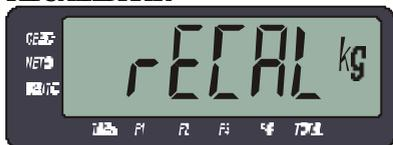
Este mensaje indica que el indicador ha echo un ajuste interno para adaptarse a las señales de entrada. En caso que este mensaje aparezca durante la toma de **CERO** deberá repetir la toma de **SPAN**, si aparece durante el ajuste de **SPAN** es necesario volver a tomar **CERO** y **SPAN**.
