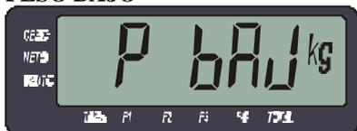
Este mensaje indica que el peso sobre la plataforma no es suficiente para la correcta calibración de **SPAN**.
