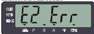
Este mensaje al arrancar indica que la memoria no volátil de configuración está dañada. Deberá reconfigurar y recalibrar el indicador.
