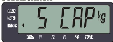
Este mensaje indica que el peso sobre la plataforma es superior a la capacidad máxima de la balanza.
