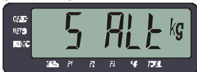
Este mensaje puede aparecer durante la calibración de **SPAN** y significa que Ud. no configuró correctamente la capacidad de la balanza (**CAP**). Para salir de este mensaje apague el equipo.
